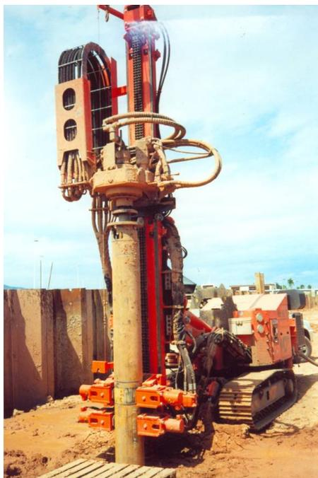
Figura 12. Maquina perforadora con sistema OD
