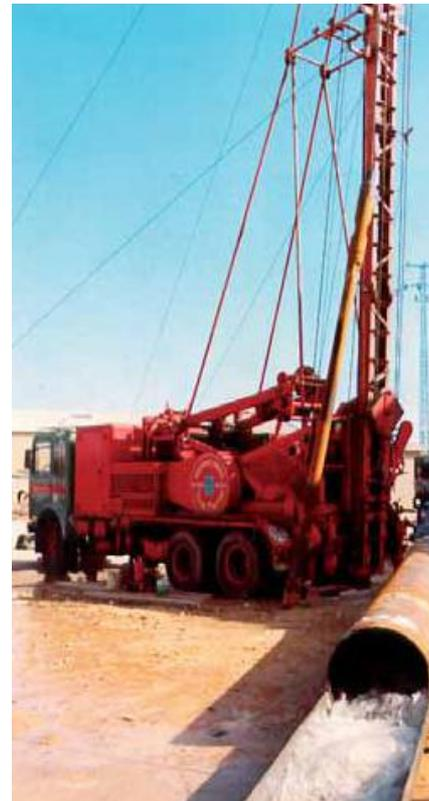
Figura 3.27.- Izda. Máquina de perforación a percusión por cable. Dcha. Esquema de válvula de limpieza y de trépano (Cortesía de FERRER, S.L.).
