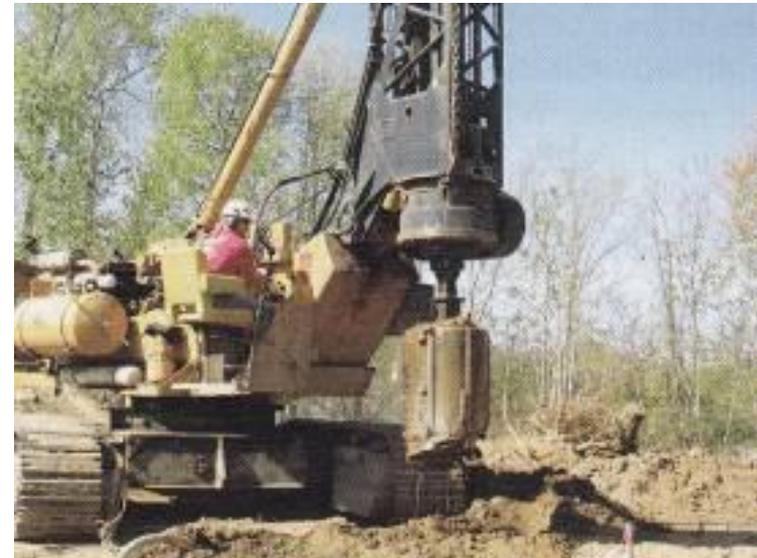
**Figura 3.20.-** Perforación con balde. (Powers et al. 2007).
