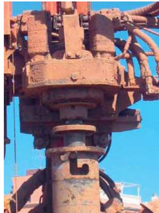
Figura 3.23.- Izda Máquina perforadora sistema OD. Drcha. Cabezal OD de acción dual (Cortesía de FERRER, S.L.).
