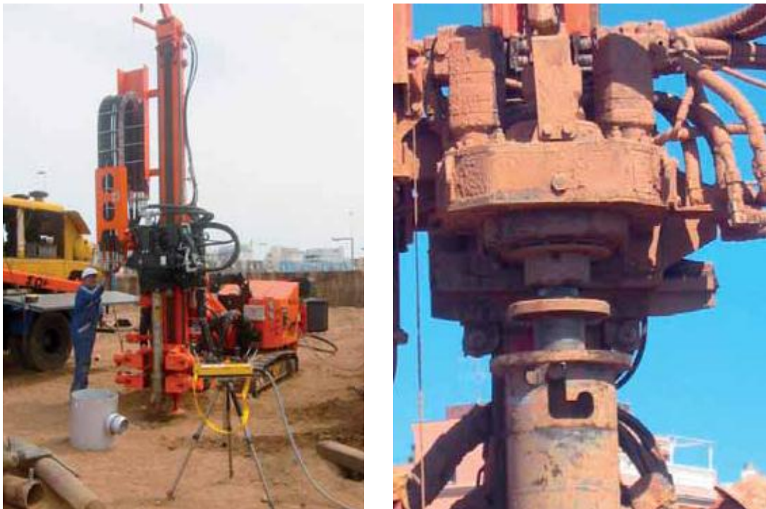
Figura 3.23.- Izda Máquina perforadora sistema OD. Drcha. Cabezal OD de acción dual (Cortesía de FERRER, S.L.).
